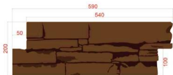
Espessura ≈ 30 a 50 mm Dimensões da Peça - Elemento Plano
